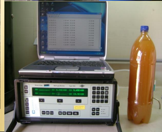
Gasanalyser Staalname: NH 3 ,CH 4
