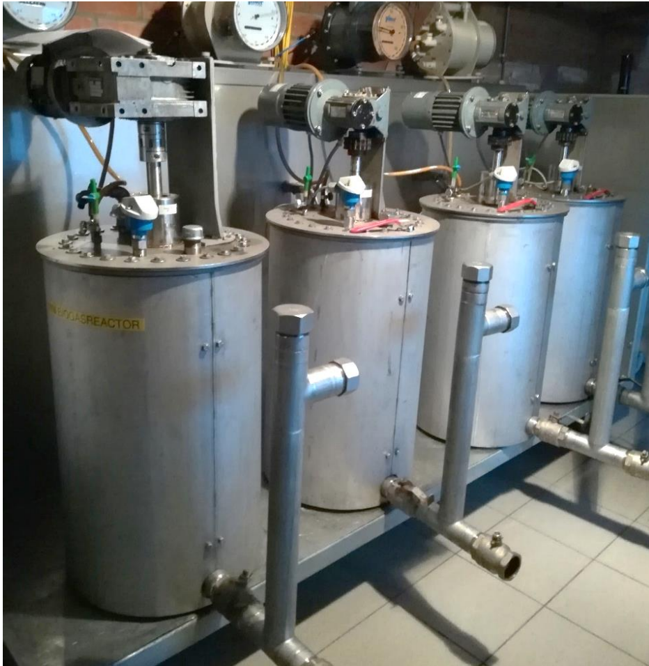
Continu geroerde tankreactor (72 L)
