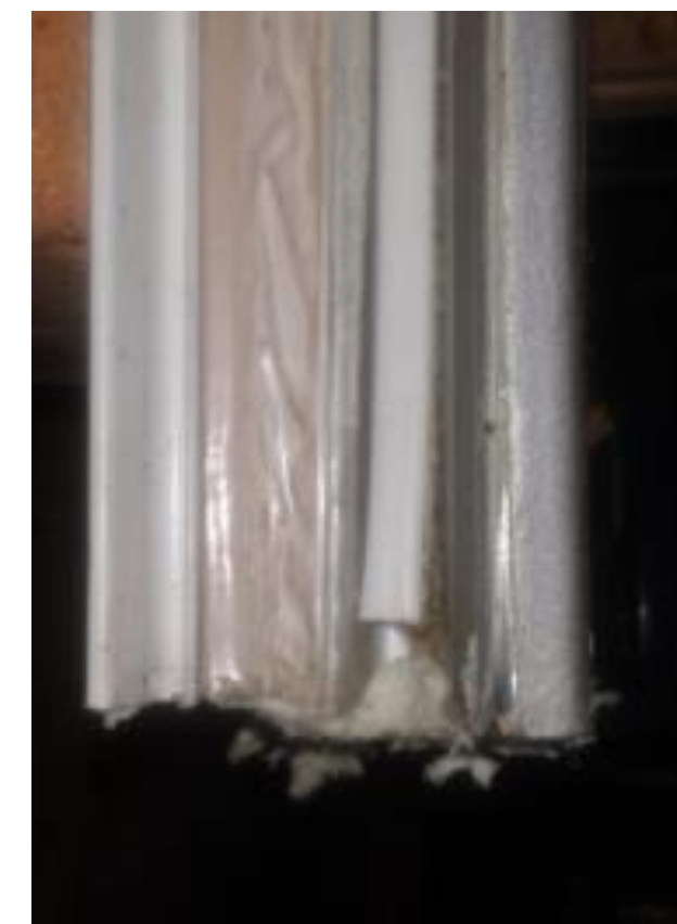
Opstelling 3: dichtingsmateriaal geïntegreerd → geen aanpassingen in situ mogelijk in geval van schade
