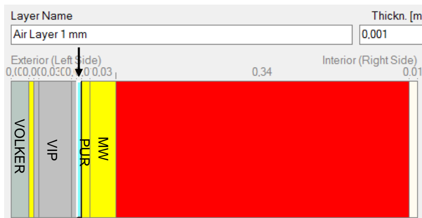
Figuur 29: WUFI model voor de evaluatie van interstitiële condensatie (met in het blauw: de denkbeeldige luchtlag).
