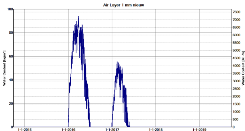
Figuur 33: Vochtgehalte in de denkbeeldige luchtlaag van de module met vezelcementplaat.
