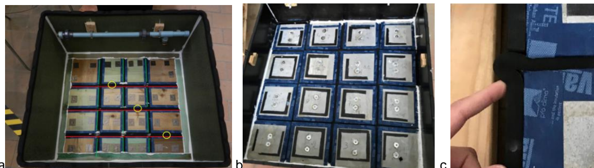
Figuur 4 (a) Opstelling met MDF (b) Opstelling met betonplaten (c) Varkensoor in een kruis met geslotencellige zwelband
