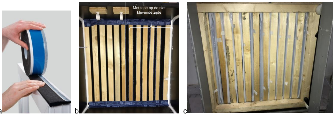
Figuur 9 (a) Opencellige tape met extra witte folie voor de luchtdichtheid (b) testopstelling voorkant (c) testopstelling achterkant met de witte folie zoals voorgeschreven volgens de fabrikant
