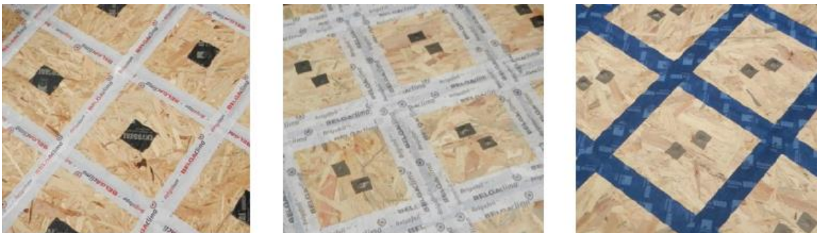
Figuur 25 De drie geteste tapes op OSB-3 (Van Linden, 2016)
