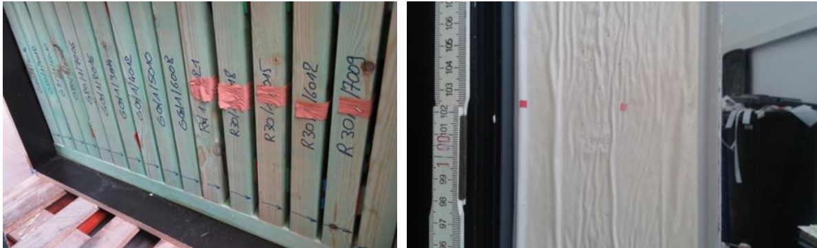
Figuur 7 (a) Vloeipapertjes bij set-up 2. Infiltratie kan tijdens de test vastgesteld worden. (b) Vochtindicatiestickers bij set-up 3. Infiltratie kan enkel na ontmanteling vastgesteld worden.
