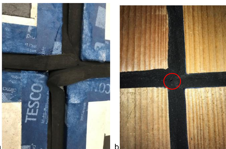
Figuur 13 (a) varkensoor met geslotencellige zweiband (EPDM), wegduwen van banden (b) varkensoor met opencellige zweiband (EPDM) kleine opening door niet optimale uitzetting van de zweiband
