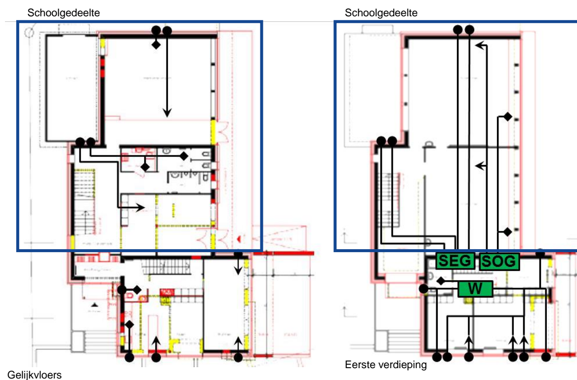
Figuur 14 Grondplan met aanduiding van de toevoer (pijltjes) en afvoerpunten (ruiten) die geïnstalleerd werden (Kobler, Dott, & Heim, 2012).
