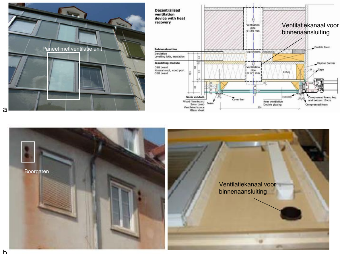
Figuur 2 (a) Voorbeeld van een paneel met een geïntegreerd decentraal systeem (b) boorgaten en kanaal om de compacte luchtgroep aan te sluiten op de ventilator binnen (IEA ECBCS Annex 50, Building Renovation Case Studies, 2011)
