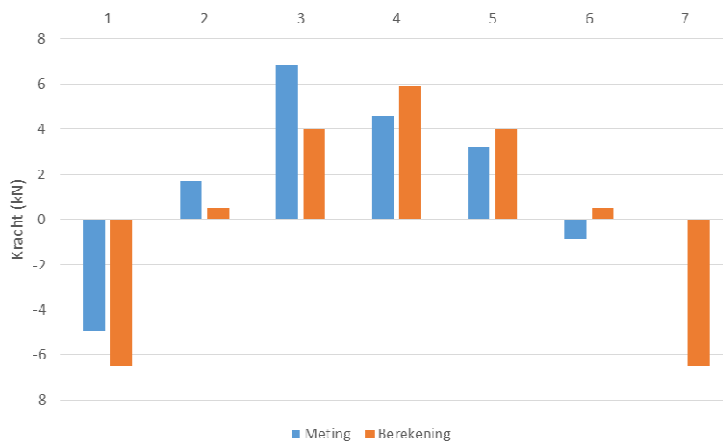
Figuur 6.3 : confrontatie meting vs berekening : krachten zonder openingen
