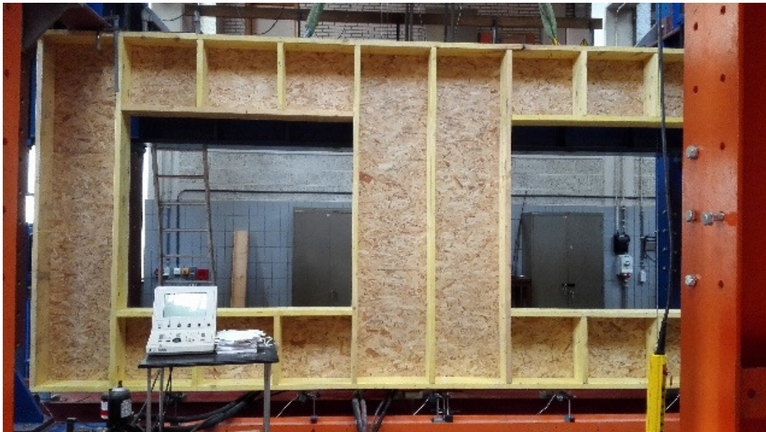
Figuur 5.16 : testopstelling met beplating met openingen
