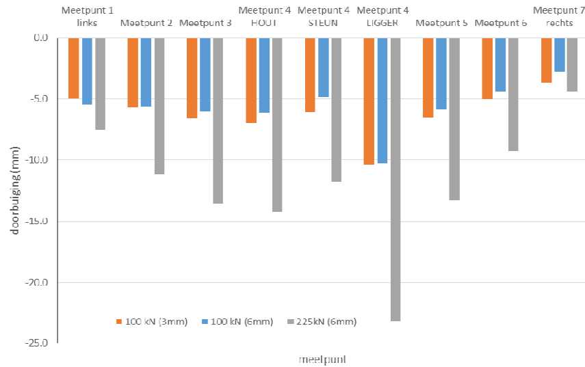
Figuur 5.15 : vergelijking van gemeten doorbuigingen bij 100 (3mm / 6mm) en 225 kN (6mm)
