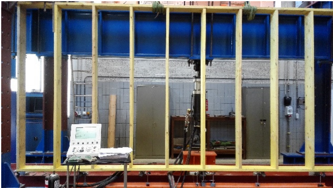
Figuur 5.6 : testopstelling zonder beplating
