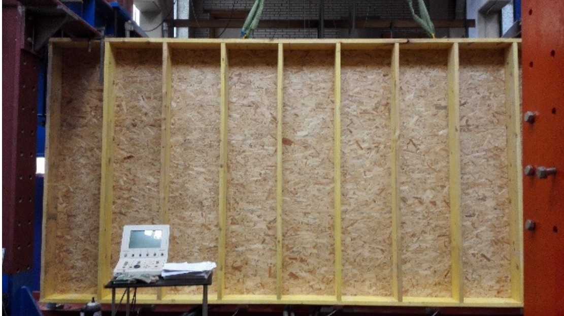
Figuur 5.10 : testopstelling met beplating zonder openingen
