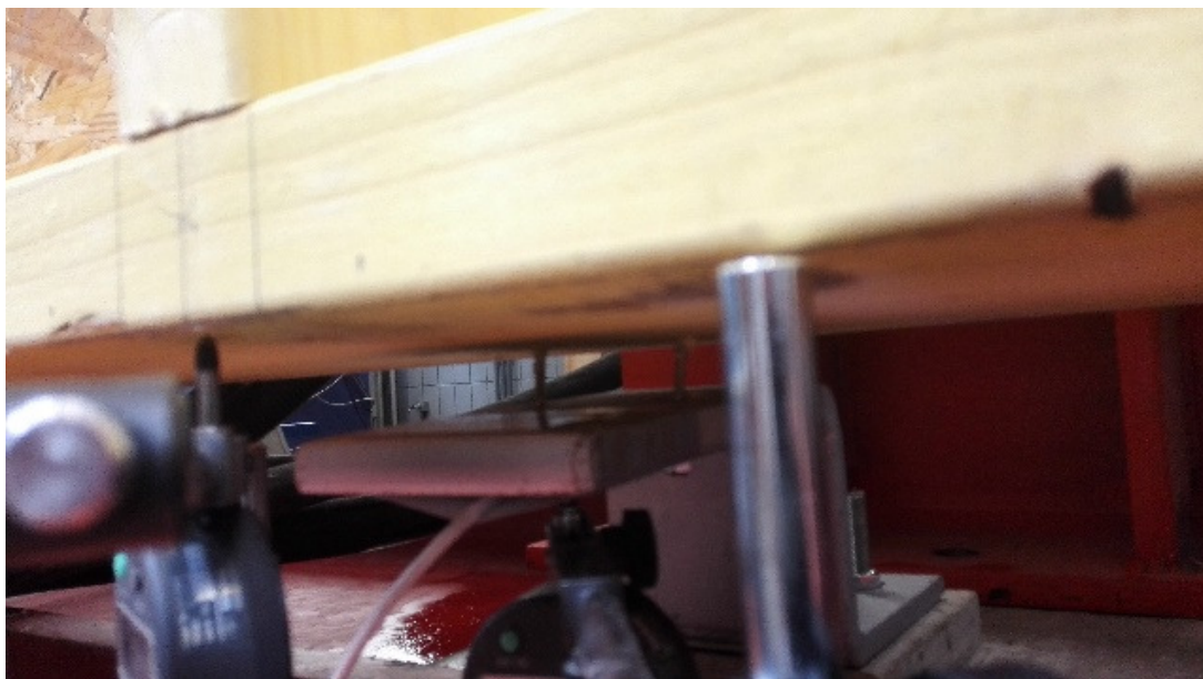
Figuur 5.11 : opening tussen caisson en steun
