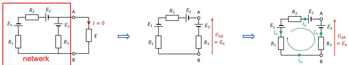
$$R_1 I_n - E_1 + R_2 I_n - E_2 - E_3 + R_3 I_n = 0 \quad \Rightarrow \quad I_n =$$
